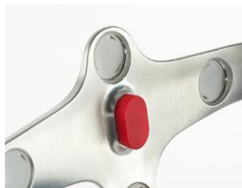
Illustration af placeringen af reflekterende markør i husene på frontal tracker.
