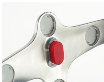
Απεικόνιση της θέσης του ανακλαστικού δείκτη στο περίβλημα του πρόσθιου ανιχνευτή.
