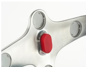
Ilustrācija, kas parāda atstarojošā marķiera novietojumu uz priekšējā izsekotāja esošajos caurumos.
