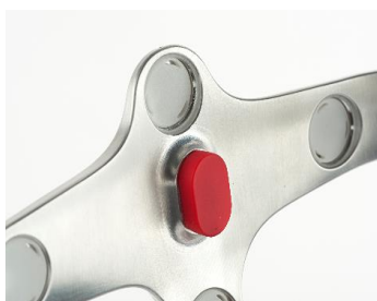
Bild på positionering av reflekterande markör i skyddshölje på den främre spåraren.
